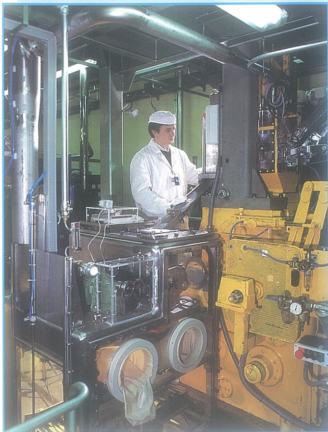
FII - Fábrica de Juzbado. Fabricación de pastillas de óxido de uranio
