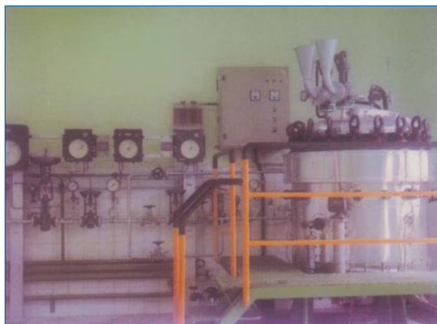
Instalación para la prueba de simulación de accidente en cámara 1m 3 . Disponible en los laboratorios de Pirelli
