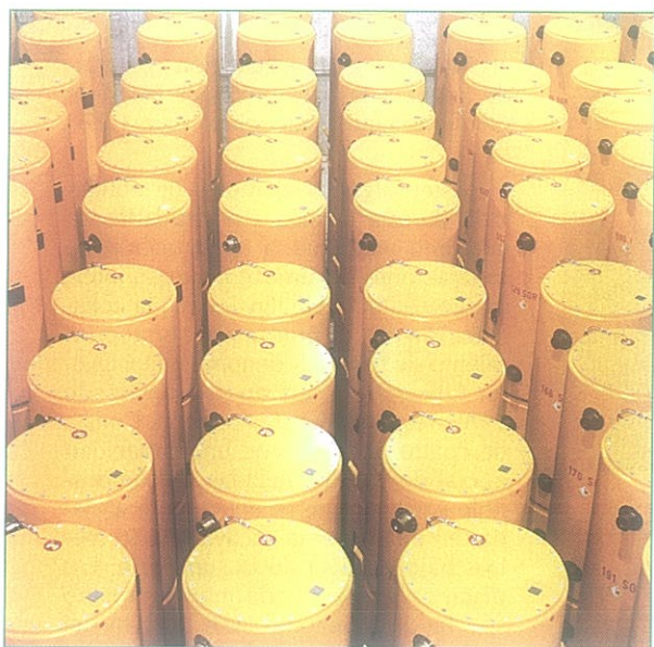
Contenedor metálico CASTOR.
