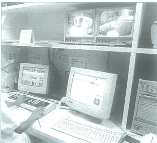
Figura 4. Puesto de control de un acelerador lineal de uso médico. (Hospital Rúber Internacional).
