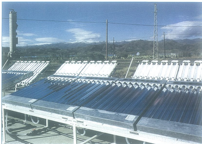
Lazo de detoxificación solar. Solar detoxification loop.
