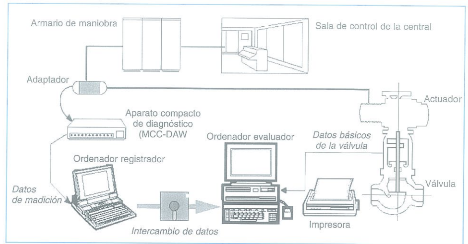
Figura 10. Análisis de fallos mediante medición de diagnóstico in situ.
