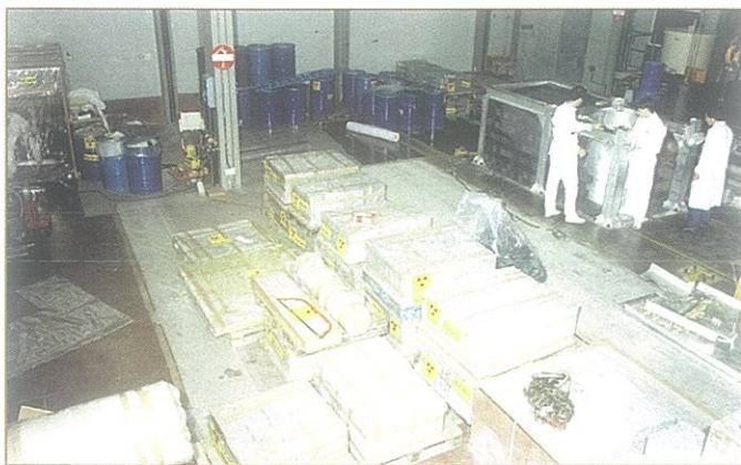
Acondicionamiento de residuos de desmantelamiento (NUCLECO, Italia).
