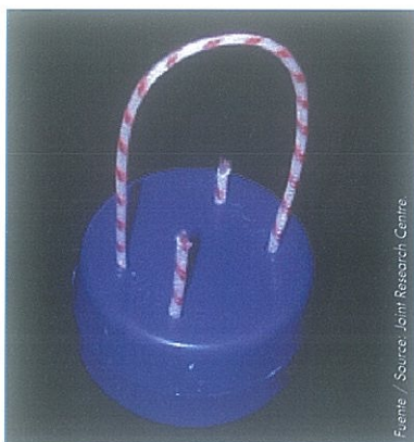
Sello utilizado por los inspectores de salvaguardias de EURATOM / Seal used by EURATOM safeguards inspectors.
