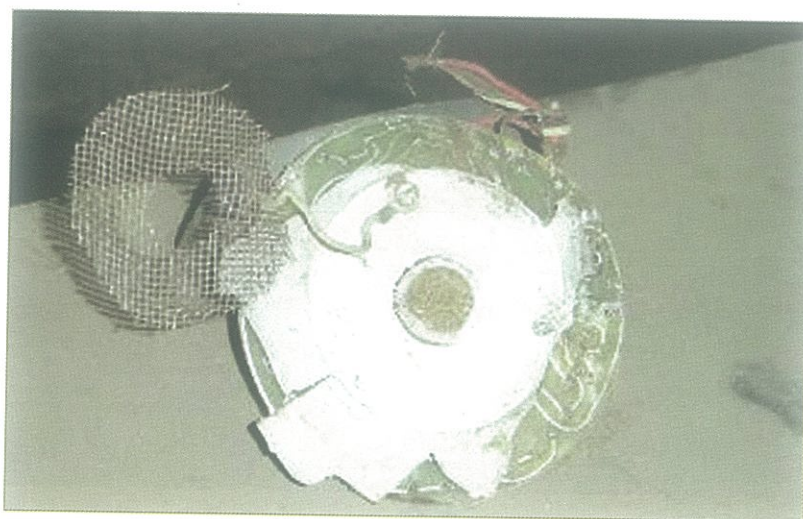
Detector de humos con fuente de Ra-226. Smoke detector with Ra-226.
