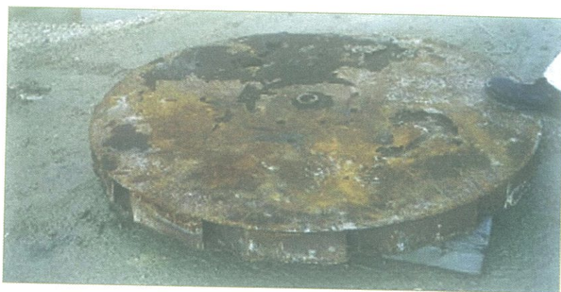
Pieza de acero contaminada con Ra-226. Steel part contaminated with Ra-226.
