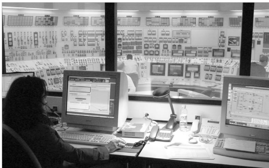
Figura 6.- Consola del Instructor del simulador.
