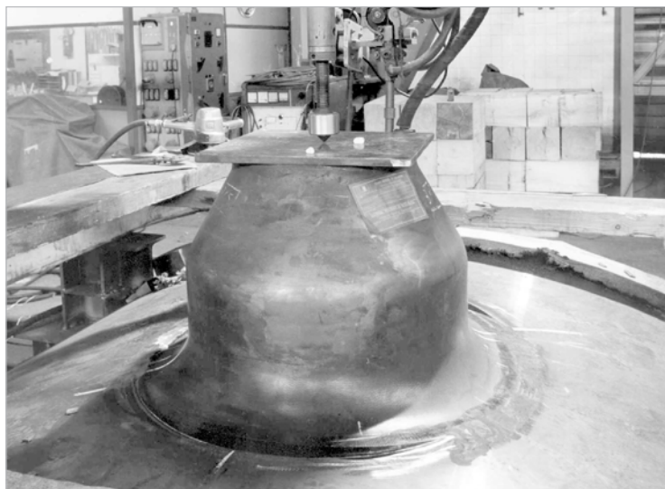
Figura nº 4. Maqueta a tamaño real para UKAEA (Reino Unido) en la que la tobera anterior va soldada a un trozo de virola.
