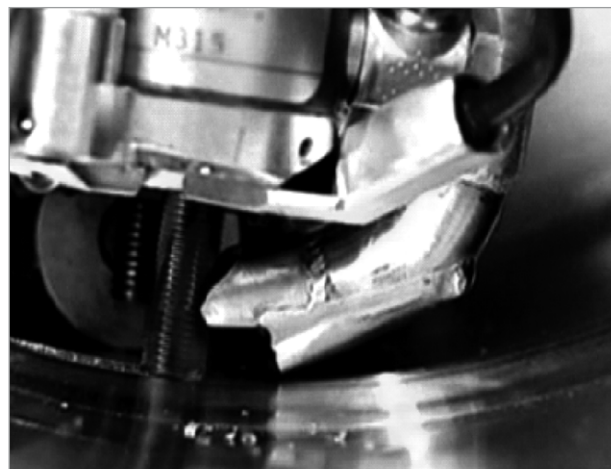
Figura 10. Operación de fresado de ID:
