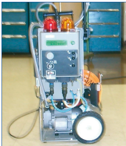
Equipo portátil de medida continua de la contaminación ambiental ABPM.
