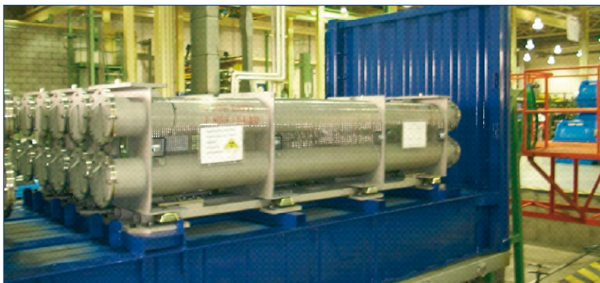
Foto 13. Contenedor combustible VVER.
