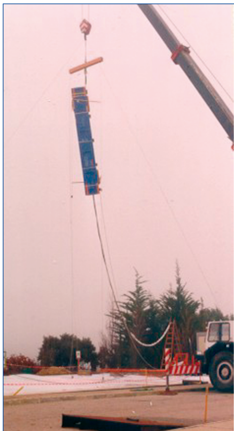
Foto 1. Ensayo caída de 9 m.
