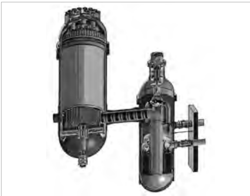
Figura 3. Proyecto ANTARES: reactor VHTR de ciclo indirecto para la producción mixta de calor y electricidad.
