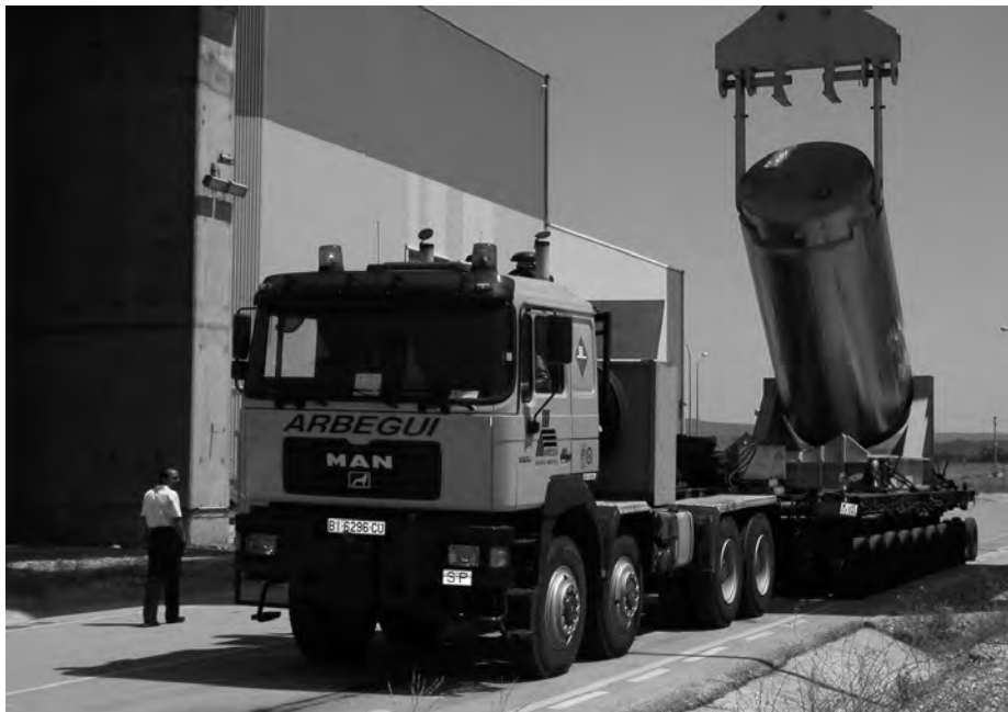
Carga del contenedor DPT para transportar al ATI de Trillo.
