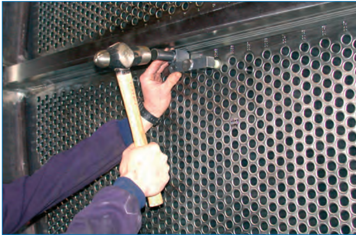
Antes. Marcado Placa Tubo Manualmente. / Before. Tube Sheet marking manually.
