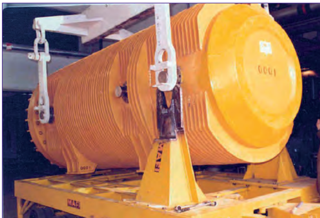
Figura 8. Contenedor antiguo de combustible gastado (en agua).
