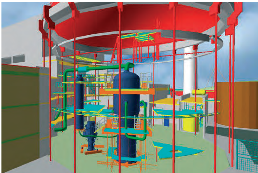
Esquema tridimensional del contenido interior del recinto de contención.
