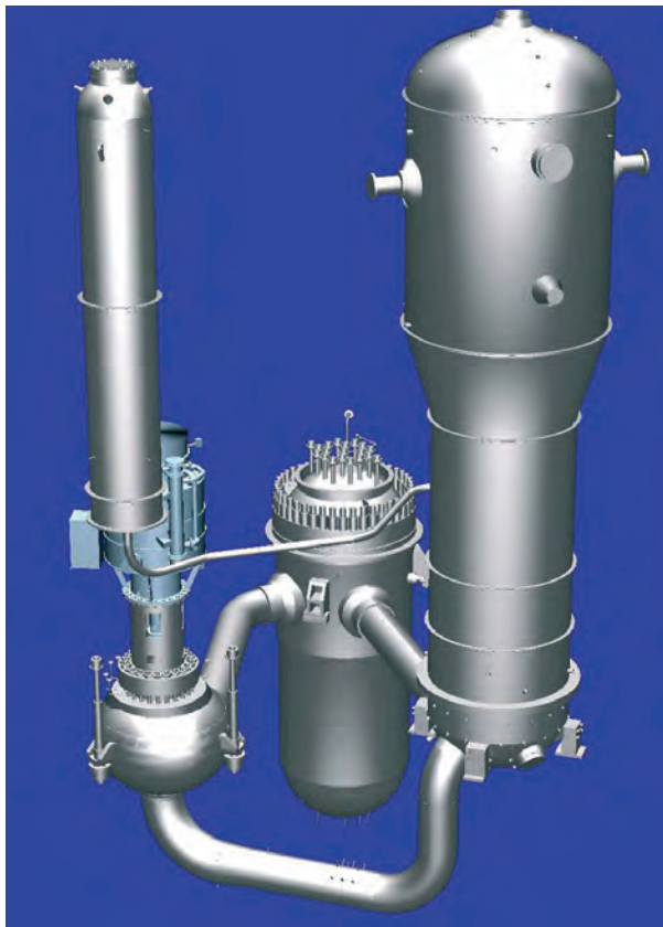
Esquema tridimensional del lazo primario de la central.
