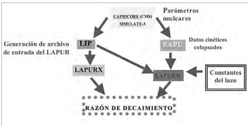
figura 1: Esquema de acoplamiento del análisis de estabilidad al sistema de vigilancia del núcleo.
