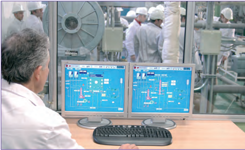
Prácticas en el Lazo Hidráulico para personal de mantenimiento mecánico, eléctrico e I&C. Vista del sistema de control distribuido.
