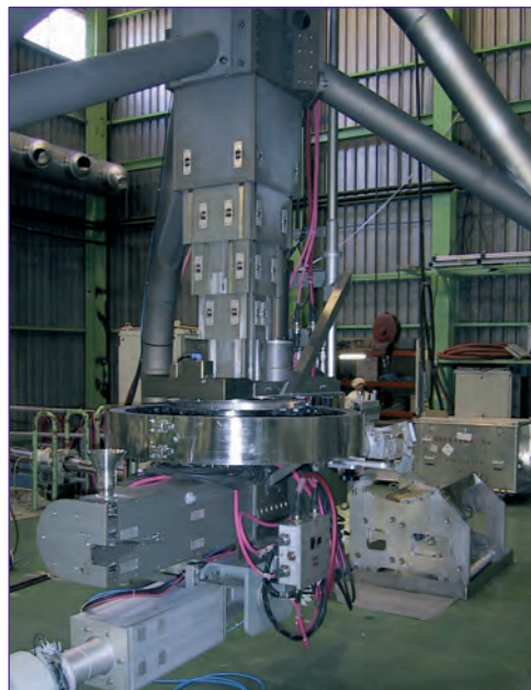
Equipo TIME de inspección de vasijas PWR y VVER. PWR and VVER vessel inspection equipment TIME.
