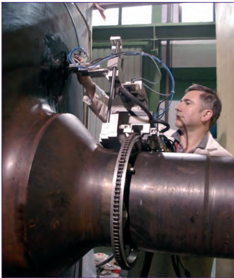
Equipo de inspección OD de toberas de vasijas BWR. BWR vessel nozzle OD inspection equipment..
