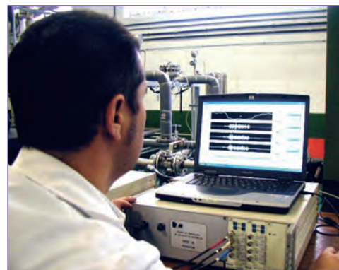
Adquisición de datos para diagnosis de válvulas de retención.
