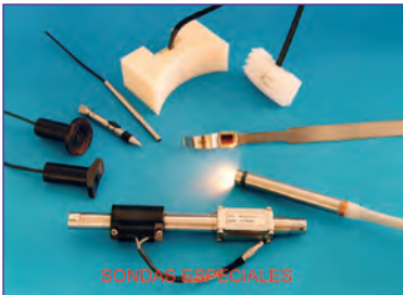
Sondas especiales de corrientes inducidas. Special eddy current probes.
