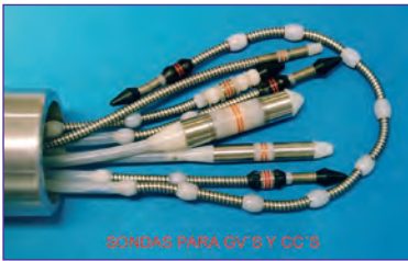
Sondas especiales para tubos de inspección. Special probes for tube inspection.
