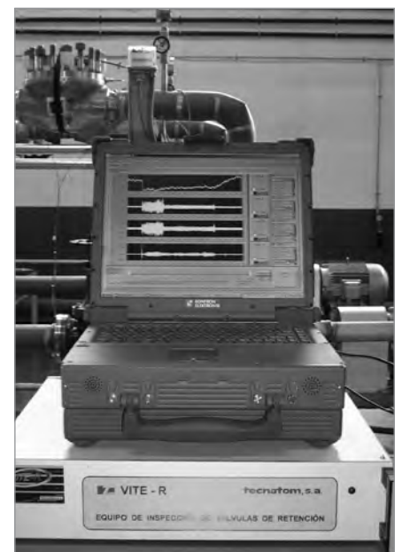
Figura 2. Sistema de diagnóstico de válvulas de retención. Pruebas en laboratorio.
