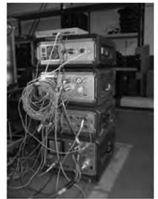
Figura 5. Gran reducción en el número de cables y componentes. a) Equipo TEDDY+SP y b) Sistema anterior empleado.
