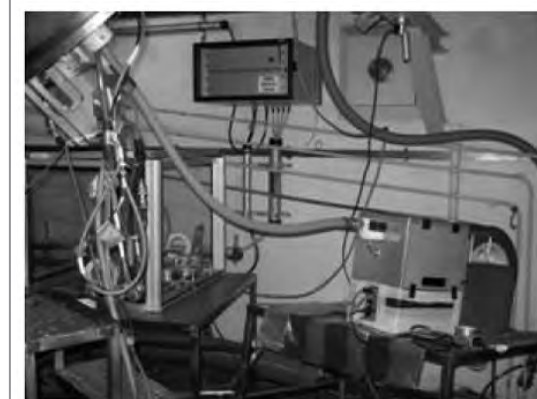
Figura 5. Gran reducción en el número de cables y componentes. a) Equipo TEDDY+SP y b) Sistema anterior empleado.
