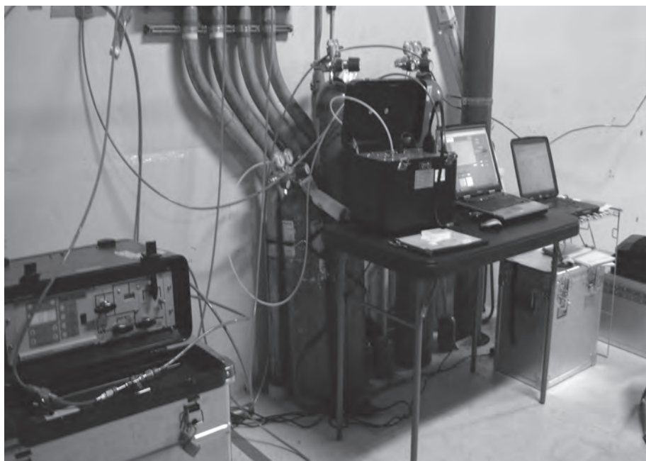
Figura 9. Sistema de Inyección del Gas Trazador
