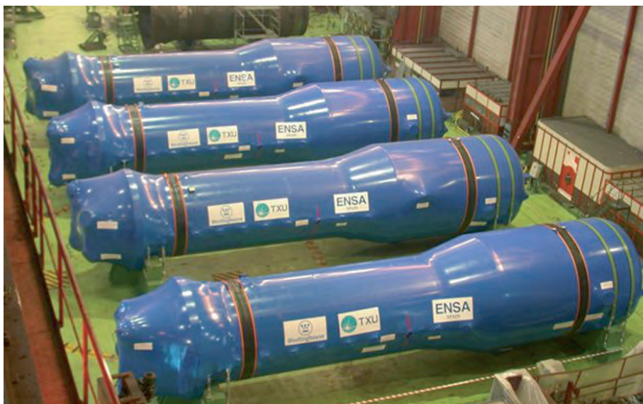
Generadores de vapor listos para embarque. Central nuclear Comanche Peak (EEUU).
