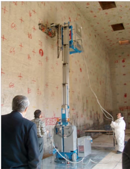
Figura 10. Prototipo para la caracterización automatizada de superficies potencialmente contaminadas. Ha sido desarrollado por el Centro Tecnológico Mestral, en colaboración con equipos de la Universidad Rovira i Virgili (Tarragona) de desmantelamiento.
