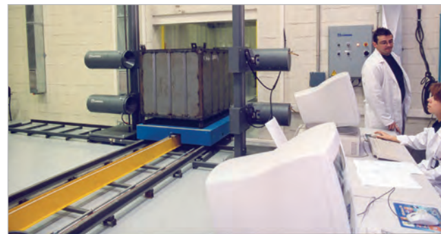
Figura 7. Medidor de Bajo Fondo. Equipo utilizado para medir la posible actividad del material limpio procedente de zonas con implicaciones radiológicas. Si los resultados estaban por debajo de los límites establecidos por el CSN, los materiales eran desclasificados y podían ser utilizados convencionalmente (normalmente se mandaban a plantas de reciclaje). Durante el desmantelamiento se desclasificaron unas 16.000 toneladas de materiales (básicamente chatarras).
