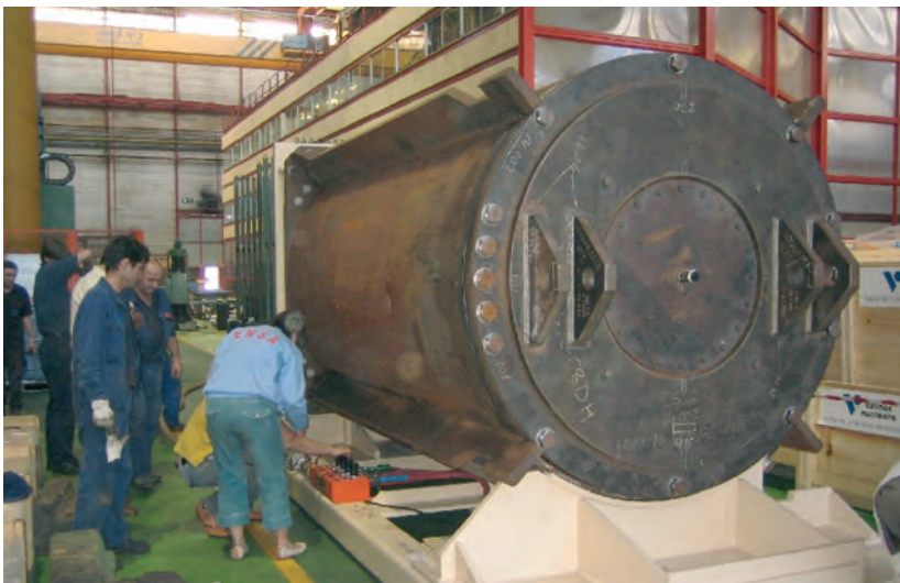
Figura 4. Plataforma de transferencia del HI-TRAC en las instalaciones de ENSA.
