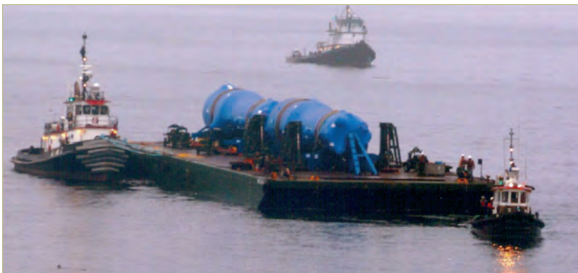
Foto 3. Generadores de vapor de ENSA llegando a la central nuclear de Diablo Canyon en los EEUU (2007).
