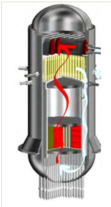
Foto 10. Esquema del prototipo de la Vasija para el reactor ESBWR de GE-Hitachi para los EEUU.
