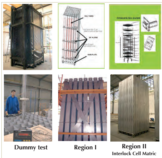
Figura 2. Racks para la CN de YongGwang en Corea. Se muestra la diferencia entre la región I y la región II.
