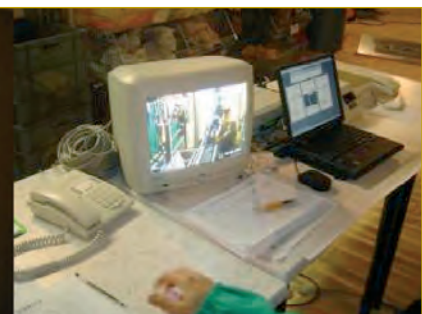
Control remoto y seguimiento de trabajos con teledosimetría en el Pozo Seco.
