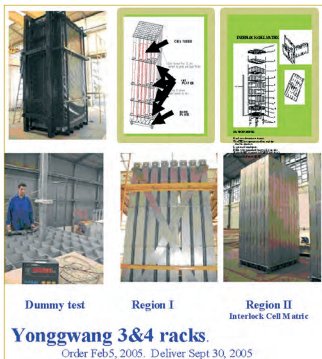
Figura 1. Racks para la CN de YongGwang, en Corea. Se muestra la diferencia entre la región I y la región II.
