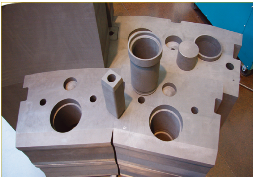
Figura 1. Piezas internas y externas de bloques reflectores de grafito del núcleo de un PBMR. (Imagen por cortesía de PBMR Ltd).
