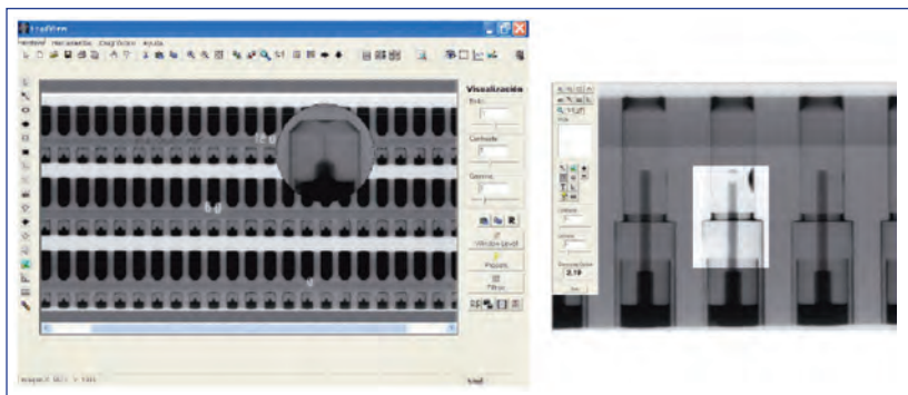
Figura 5. Ejemplo de radiografías de soldadura de sellado de tapón superior.
