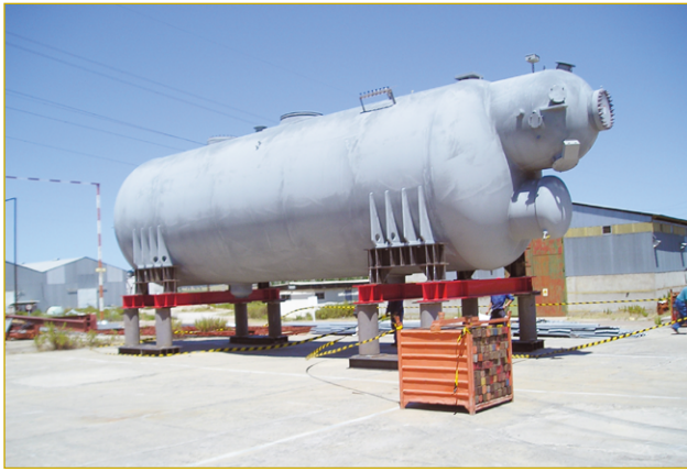
Figura 3. Detalle de estructura de apoyo.
