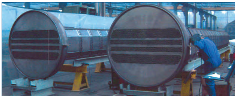
Haces tubulares en proceso de fabricación. / Manufacturing process of tube bundles.
