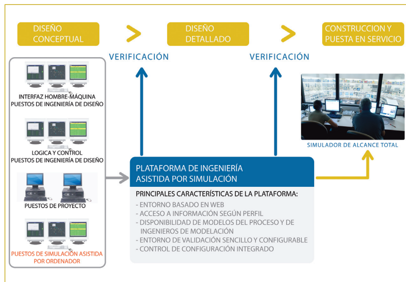
Figura 7: Esquema de integración de una plataforma SAE en un proyecto.
