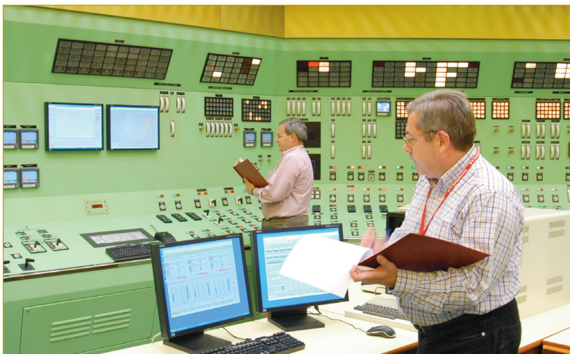
Figura 8: Verificación y validación de factores humanos en el simulador de CN Almaraz.
