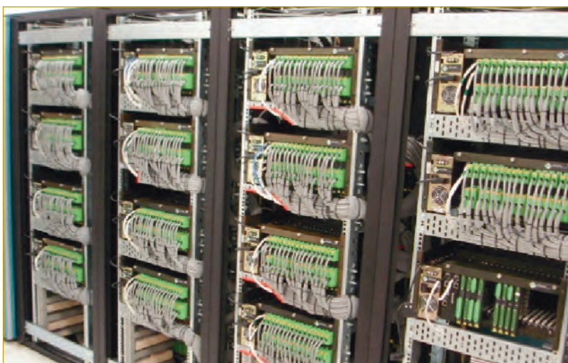
Figura 9: Sistema de adquisición de datos RTP2300.
