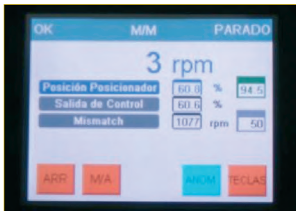
Figura 8: Pantalla táctil de operación del sistema de control de velocidad.
