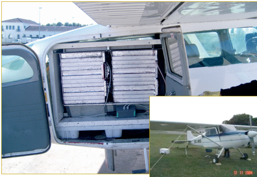
Figura 5: Aeronave de liberación con los cartuchos llenos de adultos estériles en su interior.
