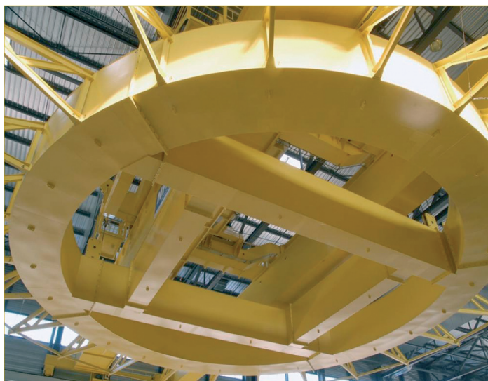
Figura 10. Grúa del interior del PF coil. Diseñada específicamente para elevar las bobinas poloidales, se observan las patas diametrales sobre las que se sujetarán las bobinas para evitar deformaciones en las mismas. Foto noviembre 2011, cortesía F4E.
