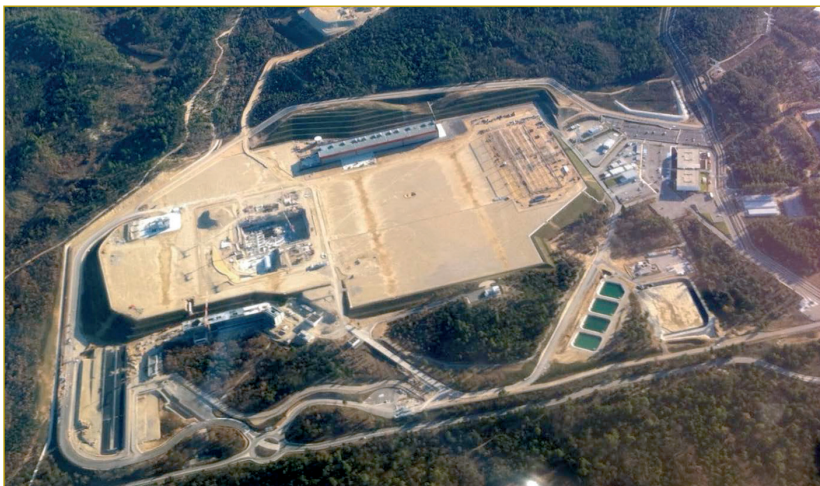
Figura 2. Vista aérea de la planta. Se observa claramente el pozo del Tokamak para aislamiento sísmico, el edificio PF coil sobre el extremo superior, la subestación de RTE a la derecha y la nueva sede de IO fuera de la plataforma junto al pozo del Tokamak. Actualmente la sede de IO y F4E se encuentra en los edificios de la derecha en la foto. Júzguese el estado de avance por comparación con la infografía de esta misma página. Foto, cortesía Engage/F4E. Diciembre 2012.
