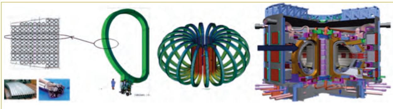
Figura 3. Bobinas toroidales de ITER.
