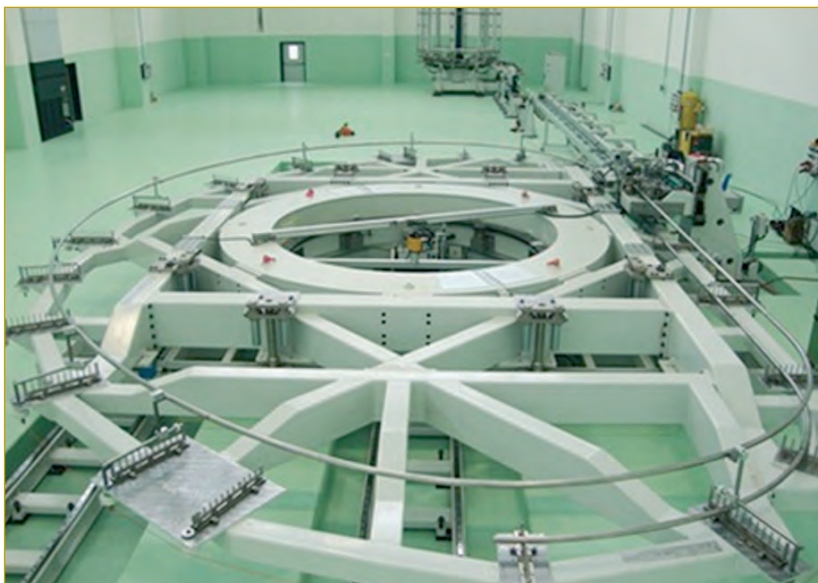
Figura 4. Winding line para fabricación de bobinas ITER.
