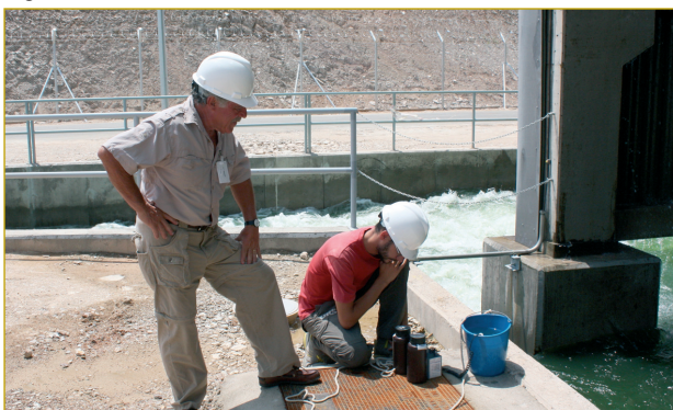
CN Almaraz. Seguimiento de parámetros físicoquímicos a la salida de la nueva torre de refrigeración
