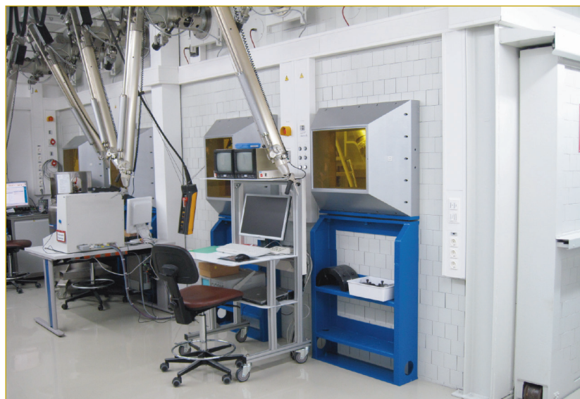
Figura 1: Celda de ensayo de materiales en el laboratorio de celdas calientes.
