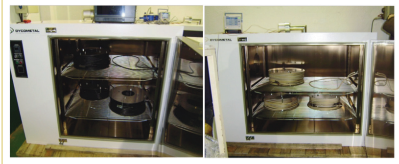
Figura 2. Envejecimiento térmico en los laboratorios de Tecnatom.
