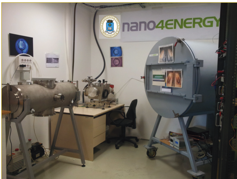
Figura 2. Fotografía del laboratorio de materiales del Instituto de Fusión Nuclear situado en la Escuela Técnica Superior de Ingenieros Industriales en la Universidad Politécnica de Madrid. En ella pueden apreciarse varios equipos de vacío para el diseño de recubrimientos a nivel de laboratorio y en gris a la derecha está una cámara de depósito que permite fabricar recubrimientos a escala semi-industrial.
