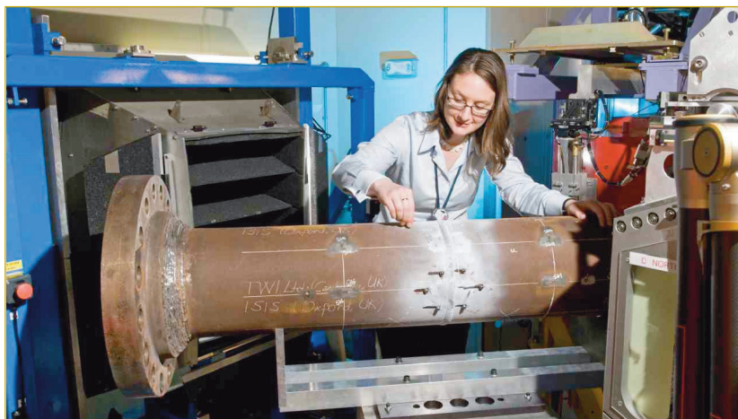
Figura 6: Posicionamiento de un elemento de tubería para la evaluación de sus tensiones residuales.
