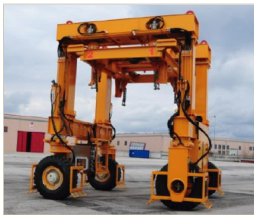
Figura 7. Grúa pórtico para izado y volteo contenedores combustible.
