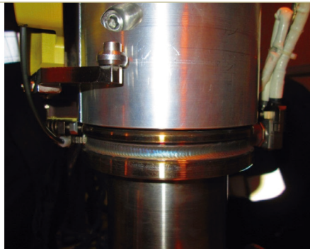
Fotos 1 y 2. Cabecial de la soldadura automática suelto y montado sobre el adaptador. (Se puede apreciar la soldadura de sellado).
