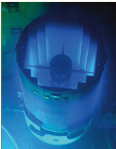
Figura 8. Efecto Cherenkov de los internos.
