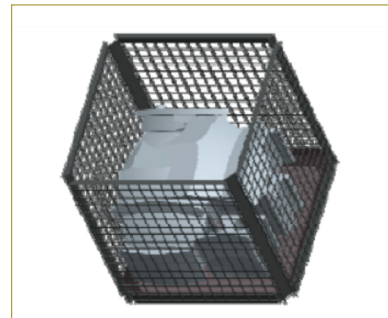
Figura 7. Ejemplo de embalaje de la tapa de la vasija en contenedores tipo CE-2a.
